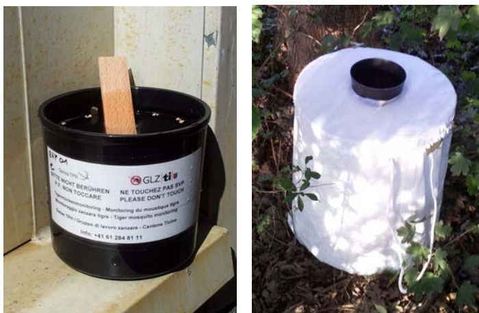
Abbildung 4: Tigermückenfallen. Links: „Ovitrap“. Rechts: BG-Sentinel Falle für ausgewachsene Mücken.
