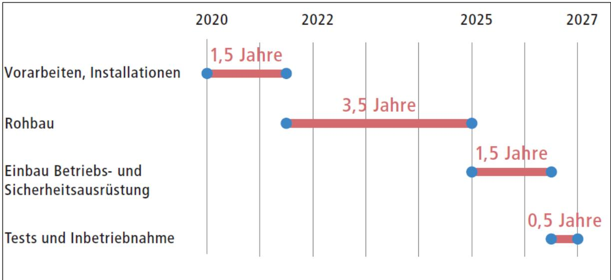
Der Zeitbedarf für die Realisierung der zweiten Tunnelröhre ab Vergabe der Hauptarbeiten beträgt rund sieben Jahre (2020-2027). Sobald die zweite, neue Gotthard-Röhre in Betrieb genommen wird, kann die bestehende Röhre geschlossen werden, damit dort die Sanierungsarbeiten in Angriff genommen werden können. Im besten Fall stehen ab 2030 beide Röhren für den Verkehr zur Verfügung.
